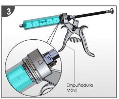
Se posiciona el pistón alineandolo justamente con la linea de 50ml. asegurando de sacar el aire del cilindro, esto se hace oprimiendo levemente la empuñadura móvil.
