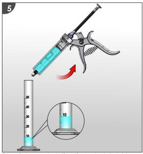
Se vacía la segunda dosificación donde el nivel del agua marcara en la probeta 10 ml.
