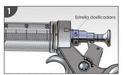
Girar la estrella dosificadora y posicionarla en la flecha de la empuñadura fija según la dosificación deseada de (1 a 5). En este caso por ejemplo se escoge la #5.
