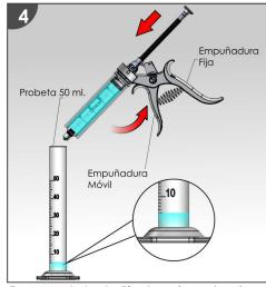
En una probeta de 50 ml. vaciamos la primera dosificación oprimiendo la empuñadura móvil donde se debe apreciar el nivel del agua de 5 ml. en la probeta.
