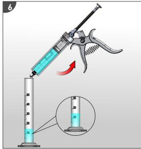
Se vacía la tercera dosificación donde el nivel del agua marcara en la probeta 15 ml.
