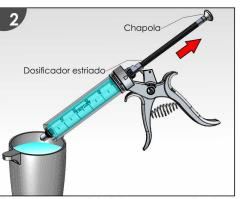
Se toma una cantidad de agua, empujando el dosificador estriado tirando de la chapola hacia atrás, hasta llenar completamente el cilindro de la jeringa.
