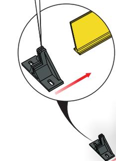
Ensamblar soportes en la pletina como se muestra en la figura.
