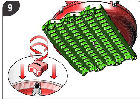
Empotrar el comedero en la base del piso, asegurándose de que la varilla quede enganchada en algún nervio. Para lograr esta operación se debe presionar fuertemente la parte superior de la tapa y girar levemente en ambos sentidos hasta enganchar.
