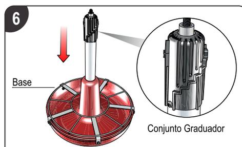
Introducir el conjunto graduador y tubo de Ø40 mm. hasta la base
