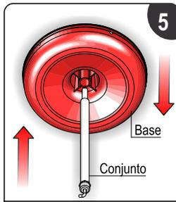
Insertar todo el conjunto: tapón, varilla, tubo Ø29, tubo Ø18 por el orificio central de la base.
