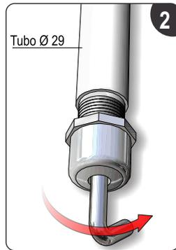
Enrosca el tapón con el tubo de Ø29 mm. hasta ajustar.
