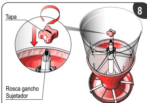
Ensamblar el conjunto de la base junto con la tolva, hélice y extensor (armados previamente) con los tornillos. Enroscar la tapa en la varilla gancho sujetador
