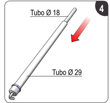
Incrustar el tubo Ø18 mm. a través del tubo Ø29 mm.
