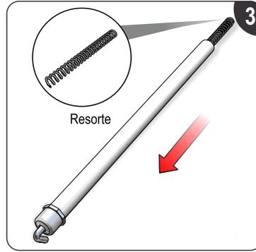
Incrustar el resorte de compresión a través del tubo de Ø 29 mm.
