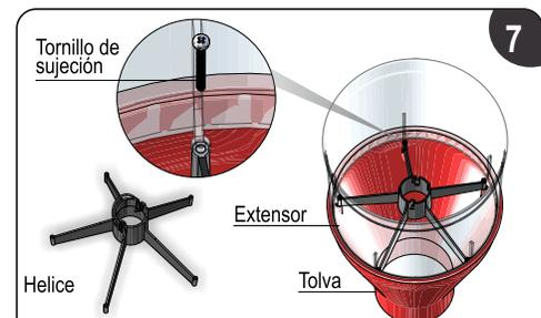
Aparte se ensambla la tolva, helice y Extensor, fijando con los tornillos los 3 componente
