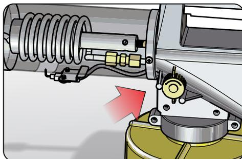
10. Gire la válvula de chequeo en posición vertical.
