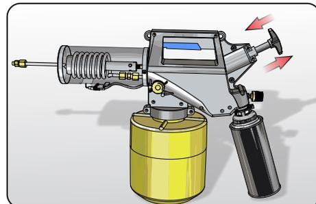
14. Limpie la bobina del nebulizador bombeando con la manija de la bomba de agua de refrigeración.
