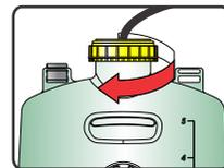
5. Introduzca el conjunto manguera dentro del tanque N°23 y ajuste.
