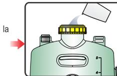
4. Llene el tanque N°23 de líquido a aplicar hasta la marca de nivel 5 Litros.
