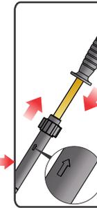
2. Introduzca la lanza completa N°10 dentro de la camara de compresión N°13 en sentido de la flecha y ajuste moderadamente.
