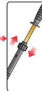
6. Comience a cargar de líquido la cámara de compresión N°13 con movimientos de ida y vuelta hasta que se logre la aspersión del líquido a aplicar.
