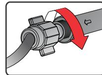
3. Ajuste el conjunto lanza N°10 y cámara de compresión N°13 con la tapa porta manguera N°16 (conjunto).
