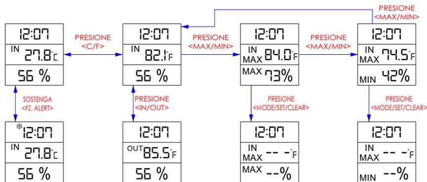
6. Cuando la humedad es de  $<40\%$ , muestra la palabra **(Dry)** "Seco"; Cuando la humedad es de  $>70\%$ , muestra el icono **(Wet)** "húmedo" y cuando la humedad entra al  $40\%$  a  $70\%$  la temperatura interior es de  $+20^{\circ}\text{C}$  y  $+25^{\circ}\text{C}$ , muestra la palabra **(comfort)**.
